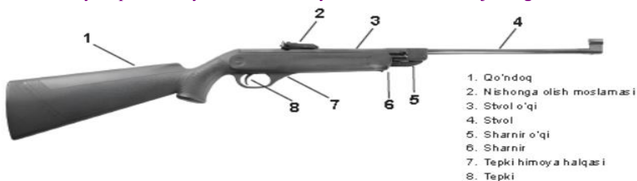
1-rasm. IJ-38 pnevmatik qurolining umumiy tuzilishi
