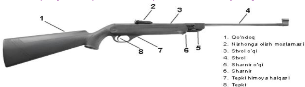
1-rasm. IJ-38 pnevmatik qurolining umumiy tuzilishi
