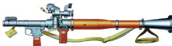
3-rasm. Tankka qarshi qo'l granatomyoti (RPG-7)ning umumiy tuzilishi
