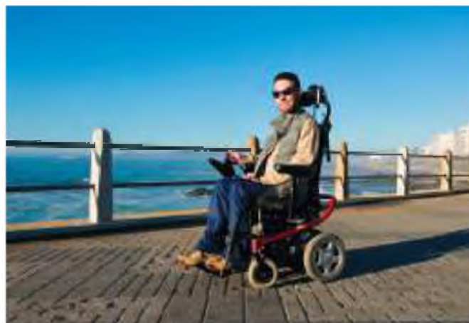
2.04-rasm. Joystik yordamida boshqariladigan nogironlar aravachasi.
