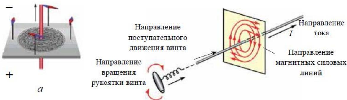
Вектор индукции ( $\rho B$ ) магнитного поля направлен по касательной к силовым линиям. В частном случае направление индукции магнитного поля в точке на расстоянии  $d$  от проводника с током приводится на рисунке 1.8 а
