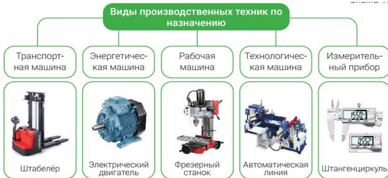
1. Транспортные машины предназначены для перемещения грузов или продукции на небольшие расстояния. К ним относятся краны, краны-манипуляторы, конвейеры, погрузчики, штабелёры и др.
