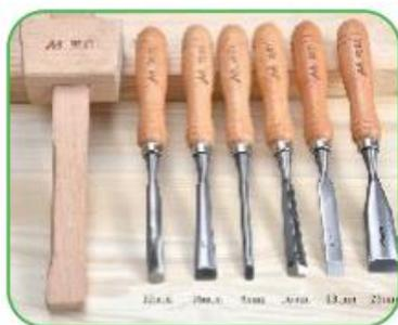
**Рисунок 30.** Инструменты для резьбы по дереву.
