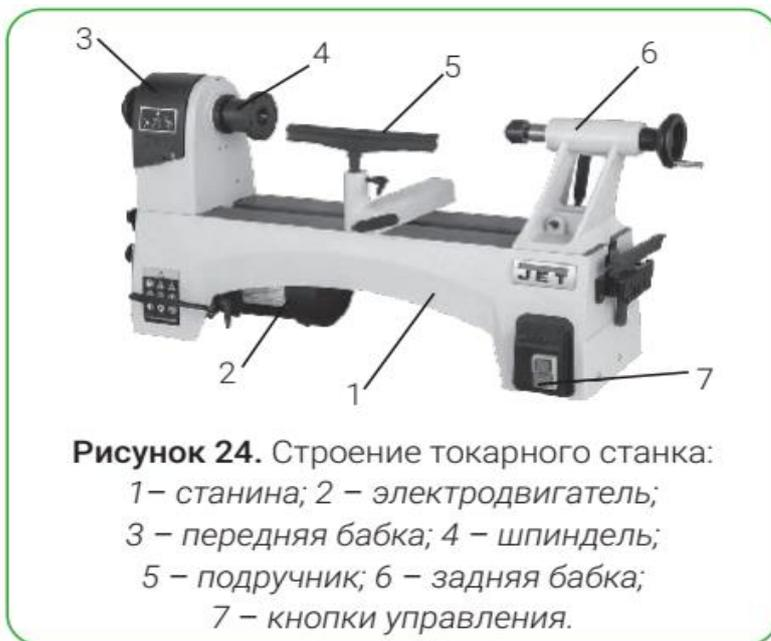
**Рисунок 24.** Строение токарного станка:
