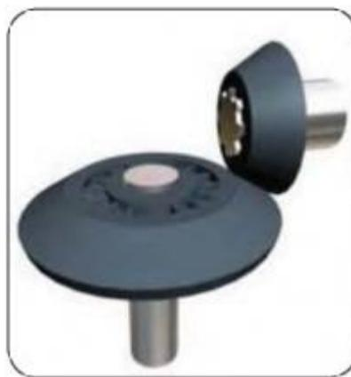
Фрикционная передача (дисковая, цилиндрическая, конусовидная) - кинематическая пара, использующая силу трения между собой для передачи механической энергии. Реечная передача - механическая зубчатая передача, преобразующая вращательное движение зубчатого колеса в поступательное движение рейки или наоборот. Если передача действия происходит с помощью жидкостей или газов, то такие механизмы называются гидравлическими или пневматическими.
