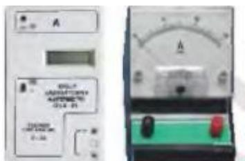
Tok kuchi maxsus asbob - ampermetr yordamida olchanadi. Ampermetr birlik vaqt davomida o'tkazgichning ko'ndalang kesimidan o'tgan zaryad miqdorini oHhashi kerak, shu sababli u zanjirga ketma-ket ulanadi
